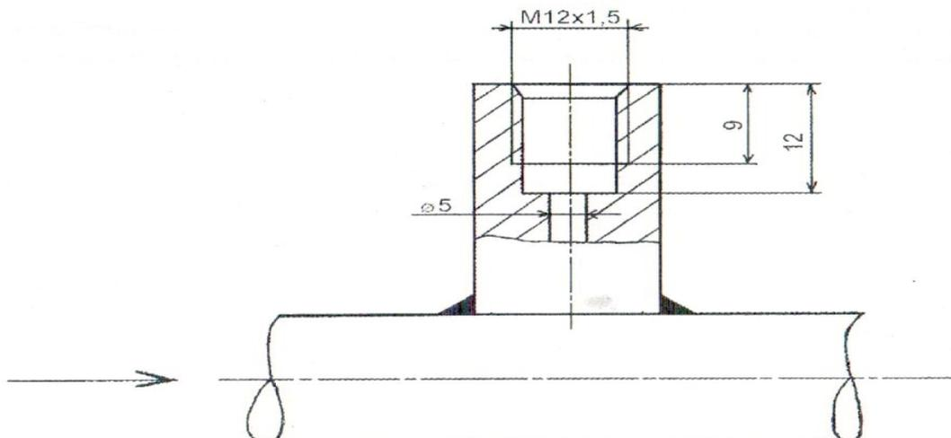
2.12 Основная схема соединения регулятора выходного давления:
