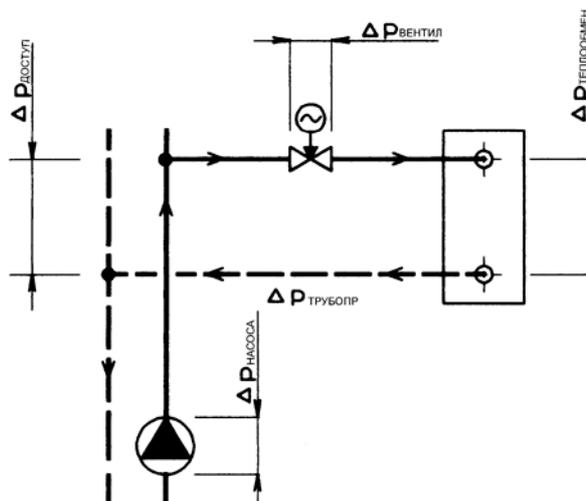
**Примечание:** подробные указания относительно расчета и проектирования регулирующей арматуры LDM приведены в инструкции по расчетам 01-12.0. Все приведенные выше отношения действительны в упрощенном виде для воды. Точный расчет лучше проводить при помощи специальной программы Ventily, которая содержит необходимые контрольные расчеты и предоставляется в распоряжение бесплатно по требованию.
